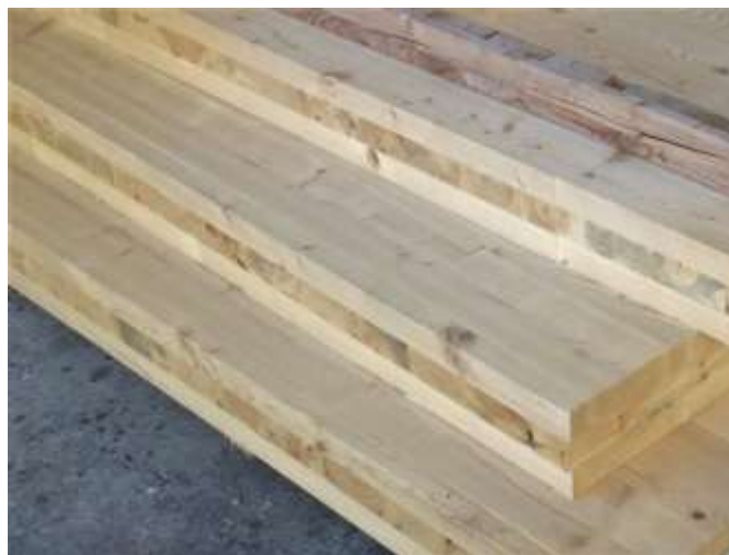
Imagen 3: Paneles contralaminados (CLT – Cross Laminated Timber)
