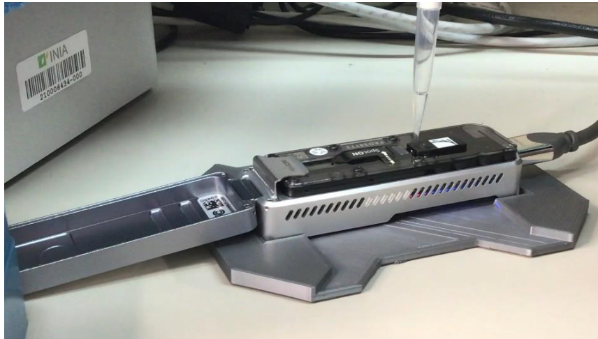
MinION: secuenciador portátil de tercera generación
